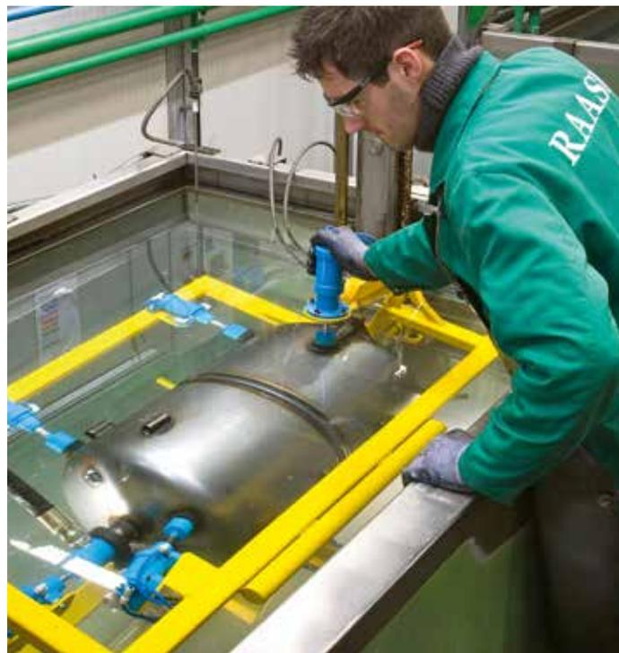
Ogni serbatoio viene testato a 6 bar di pressione per evidenziare eventuali perdite.
