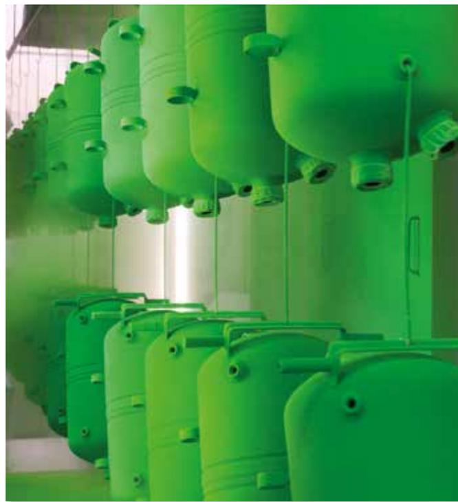
Verniciatura a polveri in resina poliesteri priva di metalli pesanti, con uno spessore medio di 100 micron.
